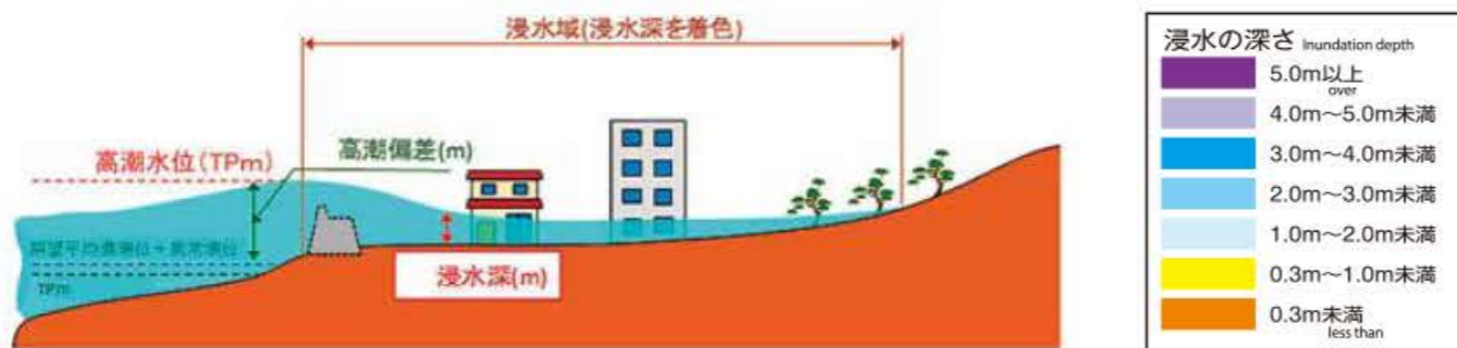
図-1 高潮水位の定義 (出典:愛知県「高潮浸水想定区域図解説書」)
