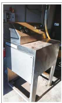
廃食油再生燃料化装置
