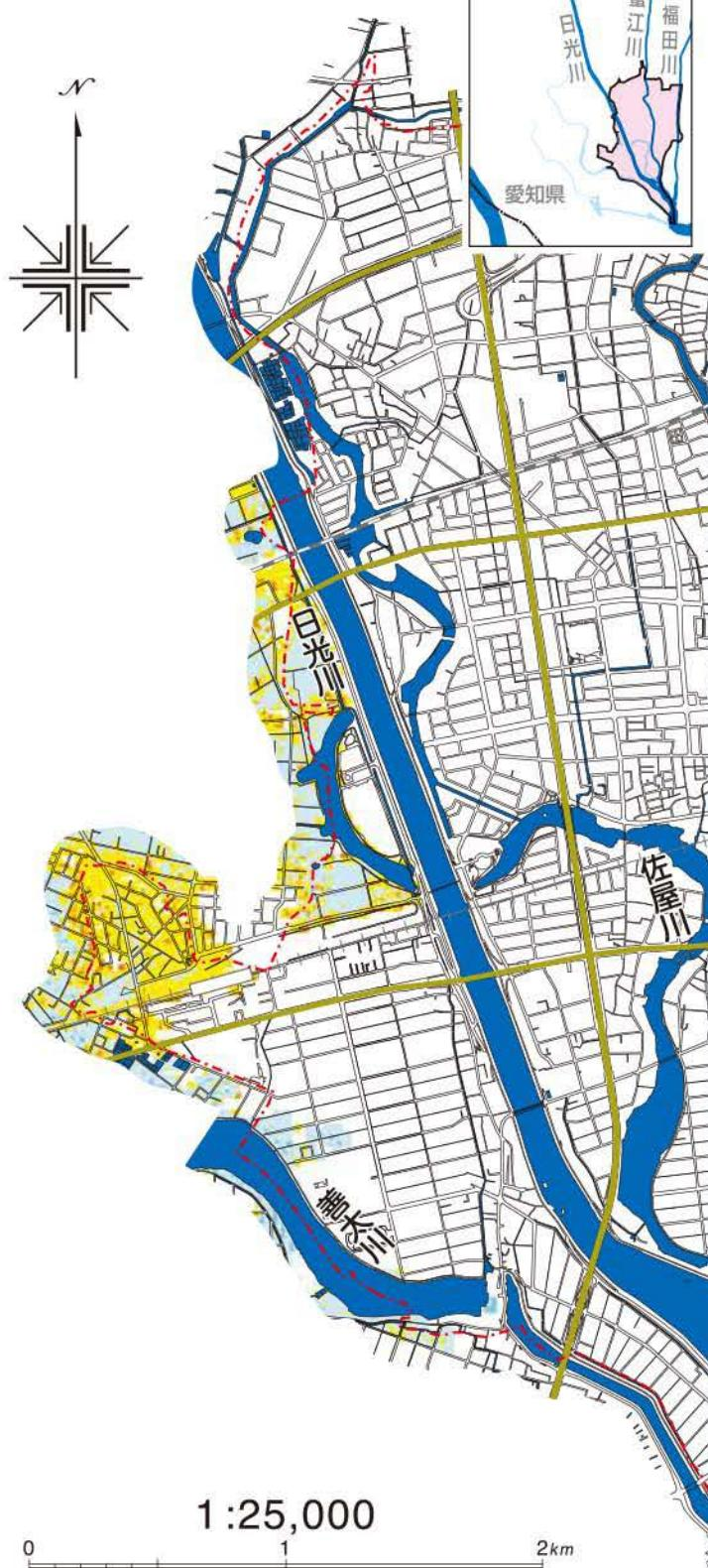
①この図は、日光川水系領内川の水位周知区間について水防法の規定により指定された想定し得る最大規模の降雨で概ね 1000 年に 1 回程度起こる大雨 (24 時間総雨量 836mm) による洪水浸水想定区域、浸水した場合に想定される水深を表示した図です。
