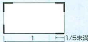
一部の外壁面で壁が1/5未満
